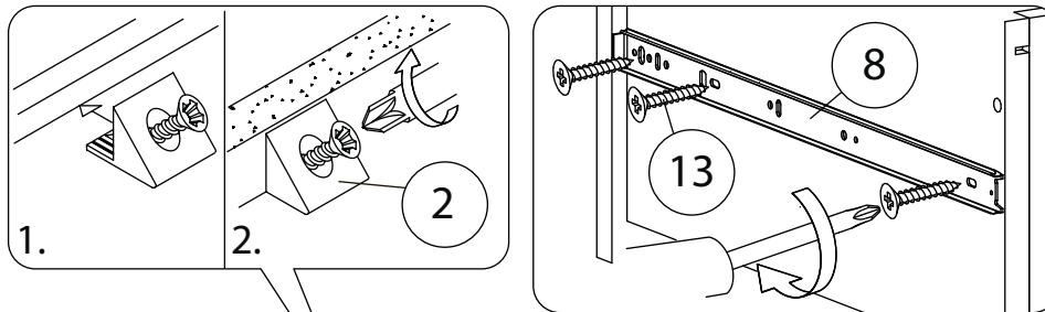
В отдельных случаях, наметки для направляющих могут не совпадать. В этом случае, нужно придерживаться горизонтали, на которой уже есть наметки и установить направляющие вручную.
