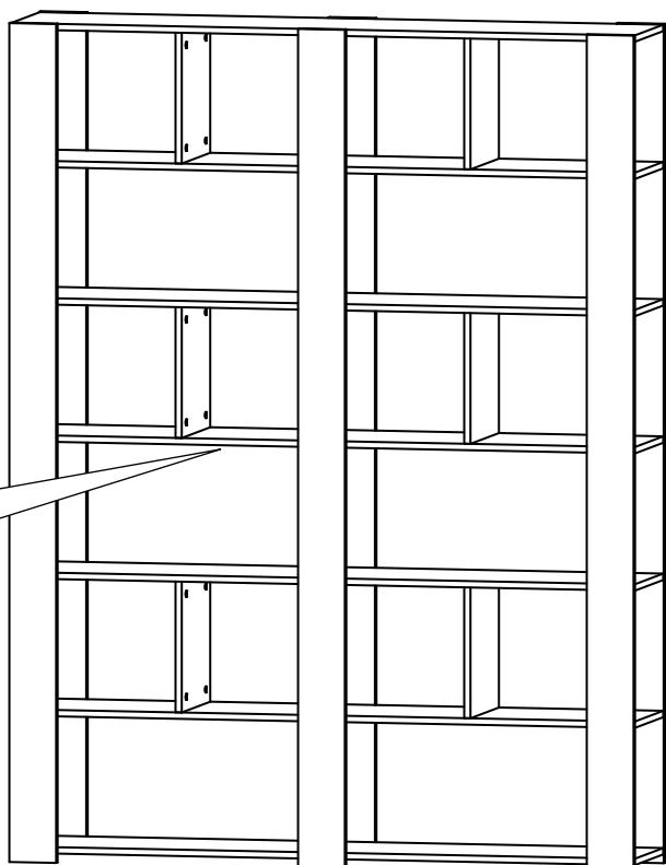
Опрокидывание мебели может привести к серьёзным телесным повреждениям. Рекомендуем зафиксировать изделие к стене при помощи мебельного навеса(10) для предотвращения его опрокидывания. Материалы стен различаются, поэтому крепежные средства не прилагаются. Используйте крепежные средства, подходящие для материала стен в Вашем доме. Для выбора крепежных средств обратитесь в специализированный магазин.
