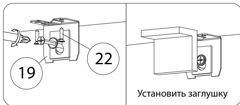
Опрокидывание мебели может привести к серьёзным телесным повреждениям. Рекомендуем зафиксировать изделие к стене при помощи мебельного навеса (19) для предотвращения его опрокидывания. Материалы стен различаются, поэтому крепежные средства не прилагаются. Используйте крепежные средства, подходящие для материала стен в Вашем доме. Для выбора крепежных средств обратитесь в специализированный магазин.
