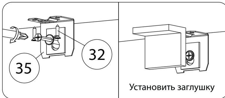
Опрокидывание мебели может привести к серьёзным телесным повреждениям. Рекомендуем зафиксировать изделие к стене при помощи мебельного навеса(35) для предотвращения его опрокидывания. Материалы стен различаются, поэтому крепежные средства не прилагаются. Используйте крепежные средства, подходящие для материала стен в Вашем доме. Для выбора крепежных средств обратитесь в специализированный магазин.
