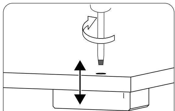
Регулировка опоры по высоте
