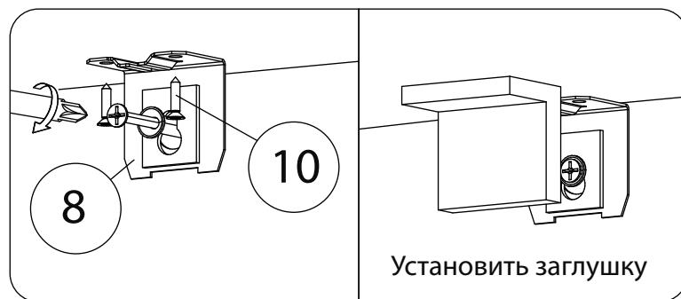
Опрокидывание мебели может привести к серьёзным телесным повреждениям. Рекомендуем зафиксировать изделие к стене при помощи мебельного навеса (8) для предотвращения его опрокидывания. Материалы стен различаются, поэтому крепежные средства не прилагаются. Используйте крепежные средства, подходящие для материала стен в Вашем доме. Для выбора крепежных средств обратитесь в специализированный магазин.
