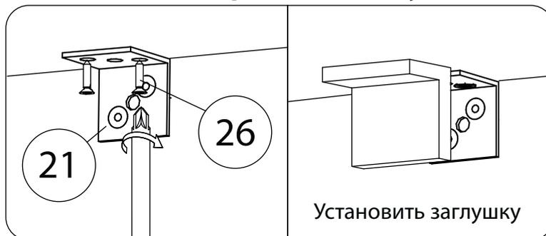
Опрокидывание мебели может привести к серьёзным телесным повреждениям. Рекомендуем зафиксировать изделие к стене при помощи уголков GRANDIS (21) для предотвращения его опрокидывания. Материалы стен различаются, поэтому крепежные средства не прилагаются. Используйте крепежные средства, подходящие для материала стен в Вашем доме. Для выбора крепежных средств обратитесь в специализированный магазин.
