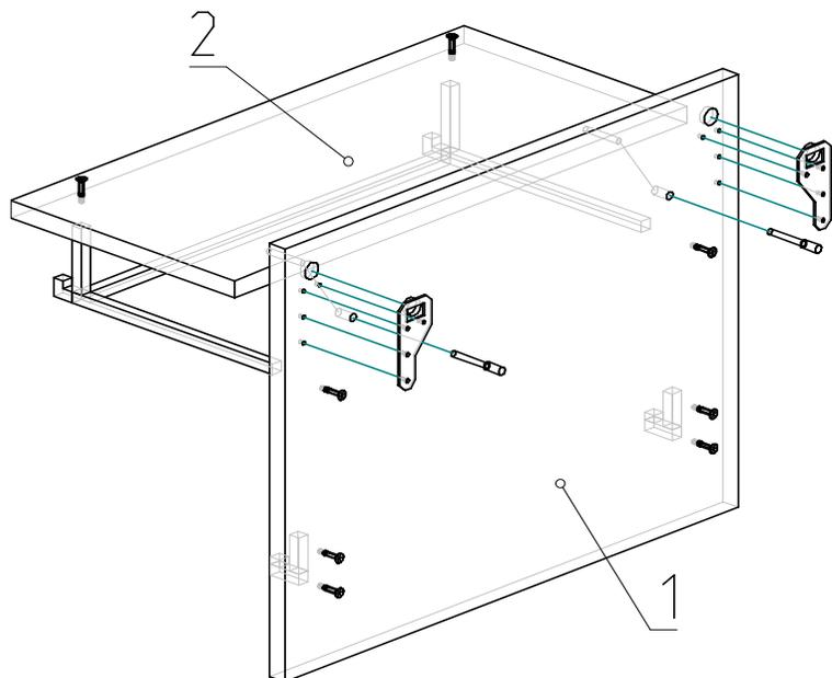
Схема сборки вешалки (рис.1)
