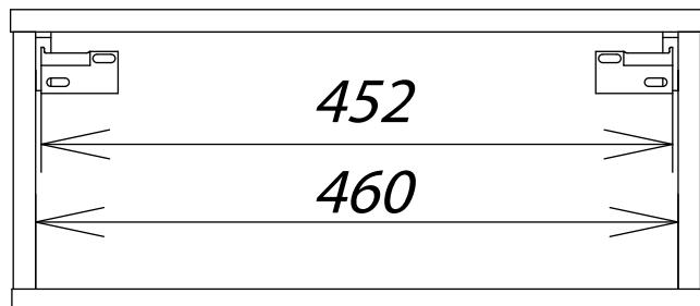
Расстояние между крайними точками планок для подвесов (1) должно составлять на 8 мм меньше (452мм), чем расстояние между внутренними поверхностями боковин (460 мм). Это необходимо для того чтобы изделие было возможно плотно прижать к стене.
