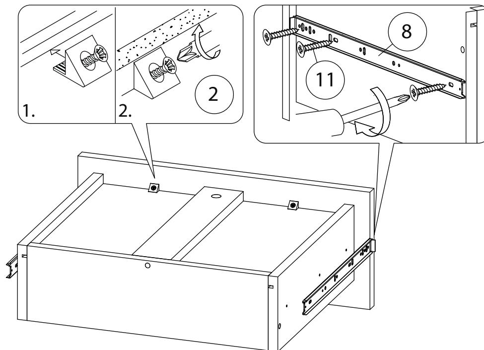
В отдельных случаях, наметки для направляющих могут не совпадать. В этом случае, нужно придерживаться горизонтали, на которой уже есть наметки и установить направляющие вручную.
