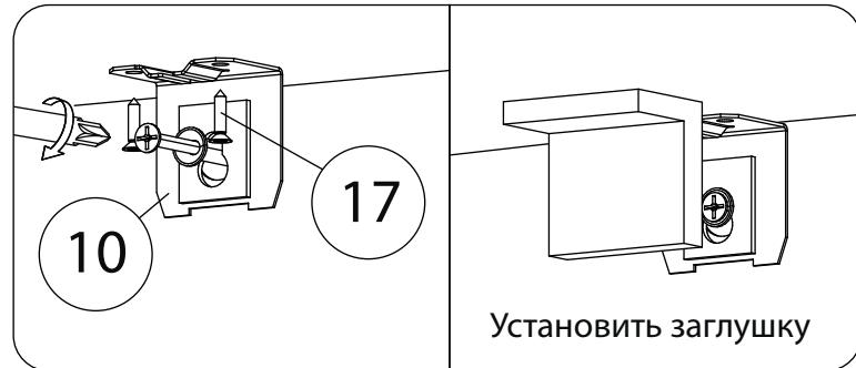
Опрокидывание мебели может привести к серьёзным телесным повреждениям. Рекомендуем зафиксировать изделие к стене при помощи мебельного навеса(10) для предотвращения его опрокидывания. Материалы стен различаются, поэтому крепежные средства не прилагаются. Используйте крепежные средства, подходящие для материала стен в Вашем доме. Для выбора крепежных средств обратитесь в специализированный магазин.
