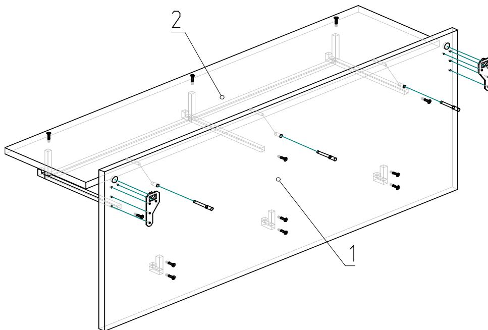
Схема сборки вешалки (рис.1)
