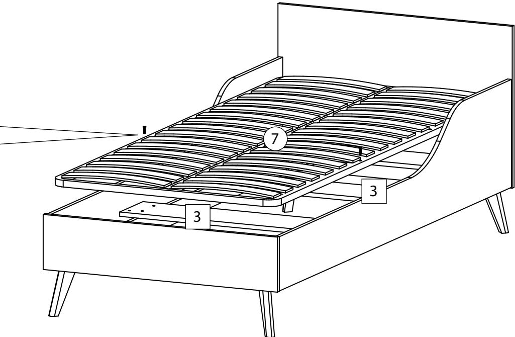
Крепление ортопедического основания (7) производится только на 2 винта (1), как показано на рисунке.
