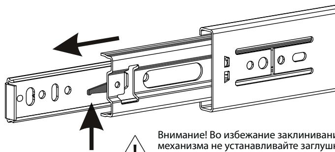
Схема установки шариковых направляющих.
