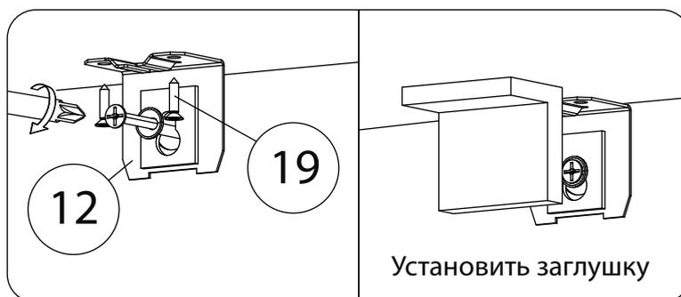
Опрокидывание мебели может привести к серьёзным телесным повреждениям. Рекомендуем зафиксировать изделие к стене при помощи мебельного навеса (12) для предотвращения его опрокидывания. Материалы стен различаются, поэтому крепежные средства не прилагаются. Используйте крепежные средства, подходящие для материала стен в Вашем доме. Для выбора крепежных средств обратитесь в специализированный магазин.
