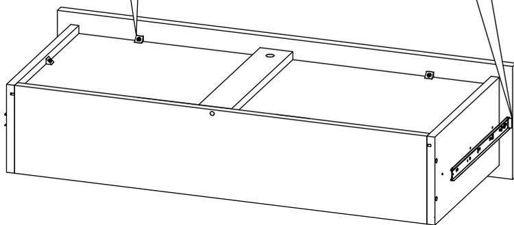
В отдельных случаях, наметки для направляющих могут не совпадать. В этом случае, нужно придерживаться горизонтали, на которой уже есть наметки и установить направляющие вручную.
