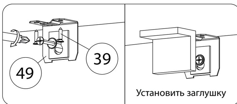
Опрокидывание мебели может привести к серьёзным телесным повреждениям. Рекомендуем зафиксировать изделие к стене при помощи мебельного навеса(49) для предотвращения его опрокидывания. Материалы стен различаются, поэтому крепежные средства не прилагаются. Используйте крепежные средства, подходящие для материала стен в Вашем доме. Для выбора крепежных средств обратитесь в специализированный магазин.
