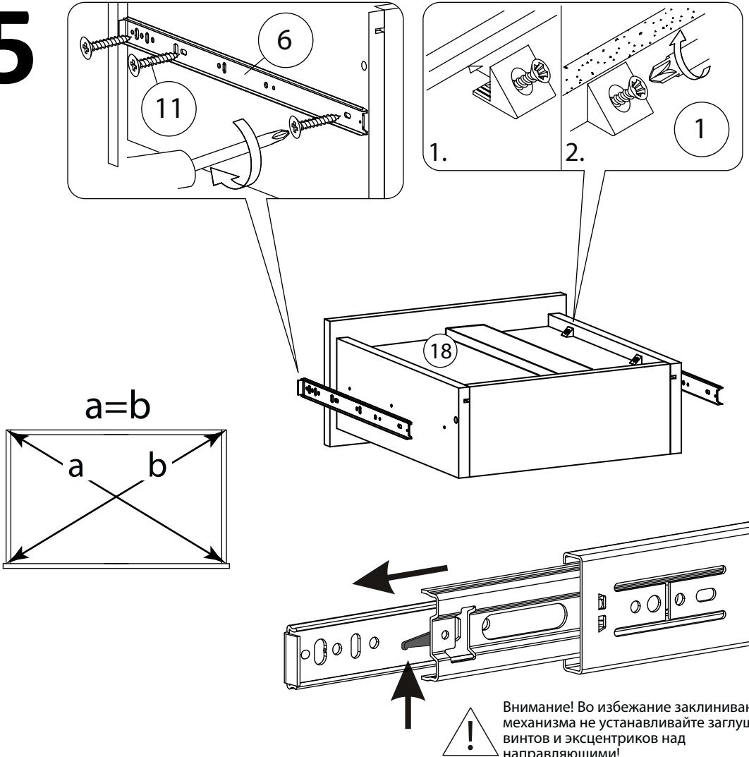
В отдельных случаях, наметки для направляющих могут не совпадать. В этом случае, нужно придерживаться горизонтали, на которой уже есть наметки и установить направляющие вручную.
