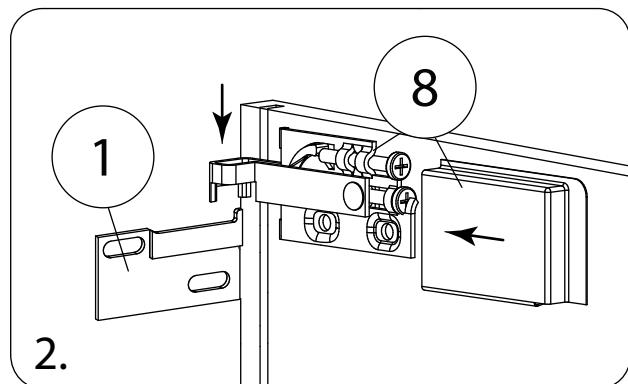
1. Разделить сдвоенные планки для подвесов (1) по технологическим линиям. на отдельные планки. Соединительная перемычка не используется.
