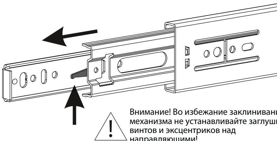
В отдельных случаях, наметки для направляющих могут не совпадать. В этом случае, нужно придерживаться горизонтали, на которой уже есть наметки и установить направляющие вручную.
