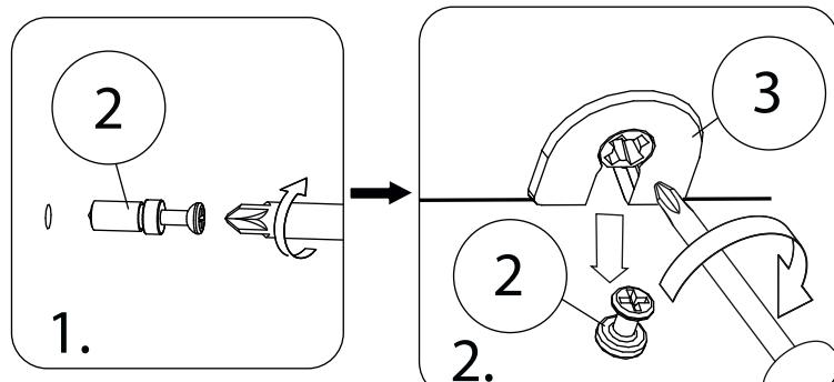
При установке блока ящиков в низ проёма шкафа , его необходимо привернуть изнутри к шкафу саморезами 3,5x30 (24).
