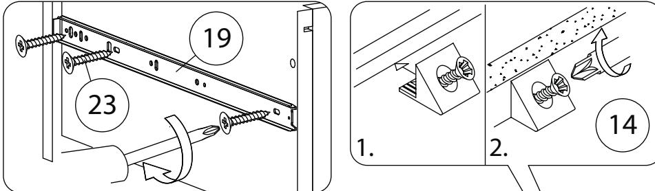
В отдельных случаях, наметки для направляющих могут не совпадать. В этом случае, нужно придерживаться горизонтали, на которой уже есть наметки и установить направляющие вручную.
