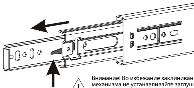
Схема установки шариковых направляющих.
