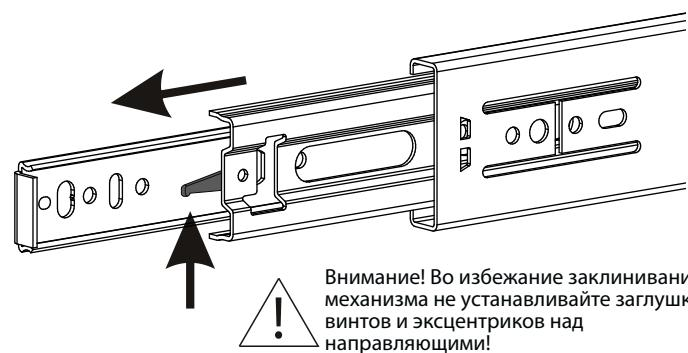
Схема установки шариковых направляющих.
