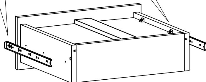
В отдельных случаях, наметки для направляющих могут не совпадать. В этом случае, нужно придерживаться горизонтали, на которой уже есть наметки и установить направляющие вручную.
