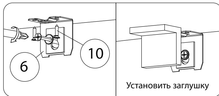
Опрокидывание мебели может привести к серьёзным телесным повреждениям. Рекомендуем зафиксировать изделие к стене при помощи мебельного навеса (6) для предотвращения его опрокидывания. Материалы стен различаются, поэтому крепежные средства не прилагаются. Используйте крепежные средства, подходящие для материала стен в Вашем доме. Для выбора крепежных средств обратитесь в специализированный магазин.
