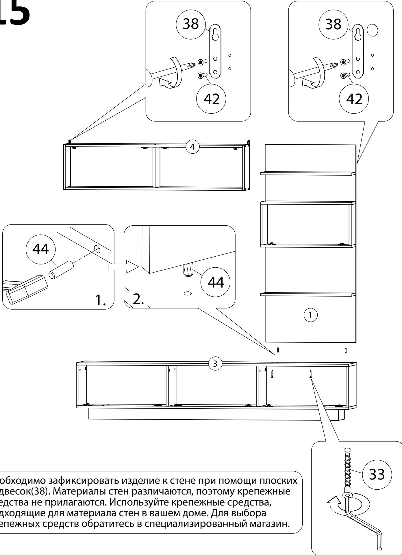
Необходимо зафиксировать изделие к стене при помощи плоских подвесок(38). Материалы стен различаются, поэтому крепежные средства не прилагаются. Используйте крепежные средства, подходящие для материала стен в вашем доме. Для выбора крепежных средств обратитесь в специализированный магазин.
