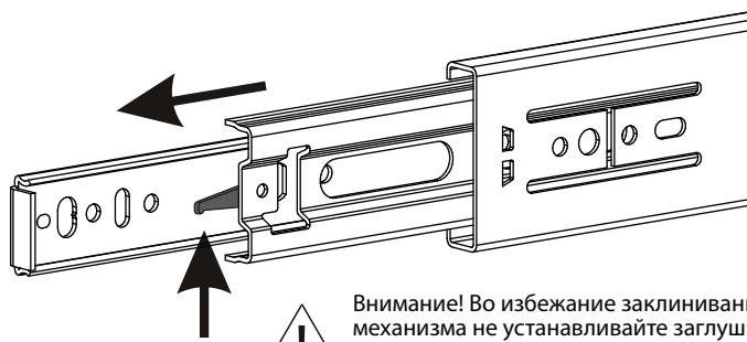
Схема установки шариковых направляющих.
