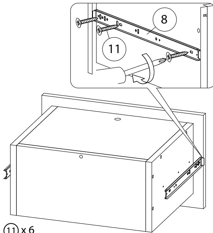
В отдельных случаях, наметки для направляющих могут не совпадать. В этом случае, нужно придерживаться горизонтали, на которой уже есть наметки и установить направляющие вручную.
