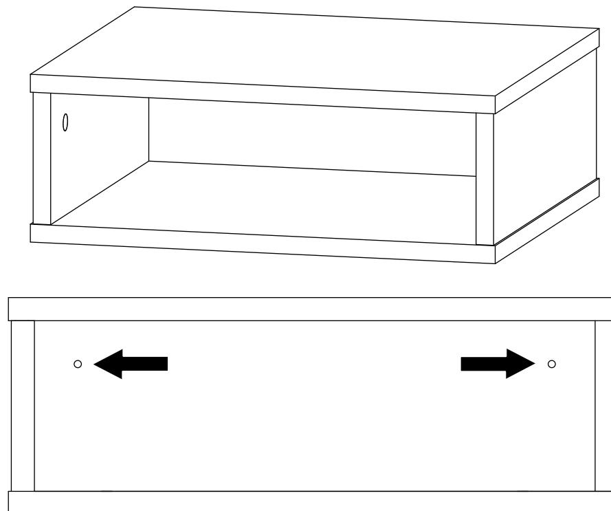
Необходимо зафиксировать изделие к стене, сквозь заднюю стенку, через крепежные отверстия.
